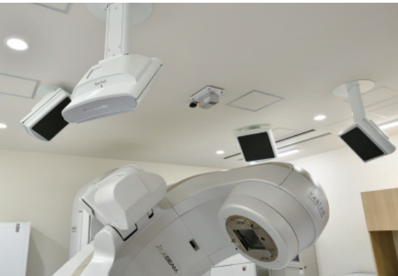
「TrueBeam」の照射室に設置された動体追跡システム「SyncTraX FX4 version（島津製作所）」。4式の12インチFPD（写真上）とX線管（写真下）を搭載することで、大視野と高精細画像での治療部位を把握できる。腫瘍近傍の金マーカーにより呼吸等の動きを追跡、最適なタイミングでの照射を実現する。バリアン社の治療計画ソフトウェアとのデータ連携も可能である。
