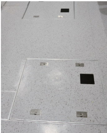
「TrueBeam」の照射室に設置された動体追跡システム「SyncTraX FX4 version（島津製作所）」。4式の12インチFPD（写真上）とX線管（写真下）を搭載することで、大視野と高精細画像での治療部位を把握できる。腫瘍近傍の金マーカーにより呼吸等の動きを追跡、最適なタイミングでの照射を実現する。バリアン社の治療計画ソフトウェアとのデータ連携も可能である。
