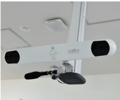
バリアン社のオプティカルイメージャ。SyncTraXと併用することで体動をモニタリングし、正確なゲーティング照射を支援し、低侵襲による動体追跡照射を実現している。
