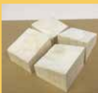
9センチ角のブロックに加工
